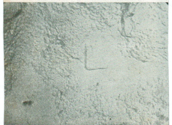
Fig. 4. Cement met boorzout; geëtst; 7300 X.
