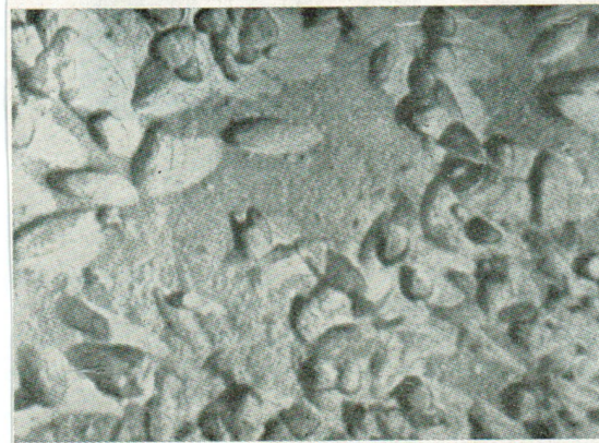
Fig. 7. Cement met \text{Na}_2\text{SiF}_6 ; ongeëtst; 7600 X.
