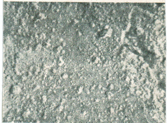
Fig. 9. Cement met \text{NaAlO}_2 ; ongeëtst; 7600 X.
