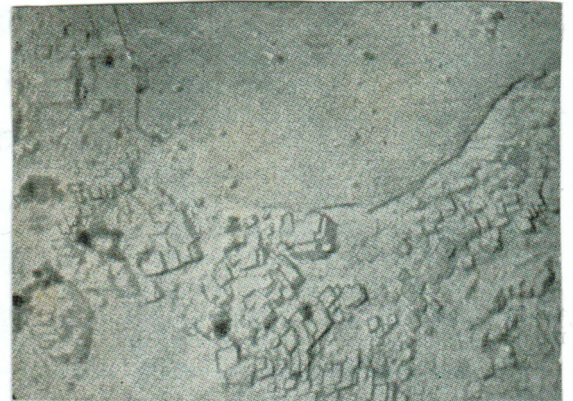
Fig. 2. Cement zonder toeslag; geëtst; 7800 X.
