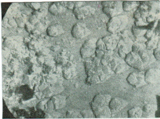
Fig. 5. Cement met polyfosfaat; ongeëtst; 6900 X.
