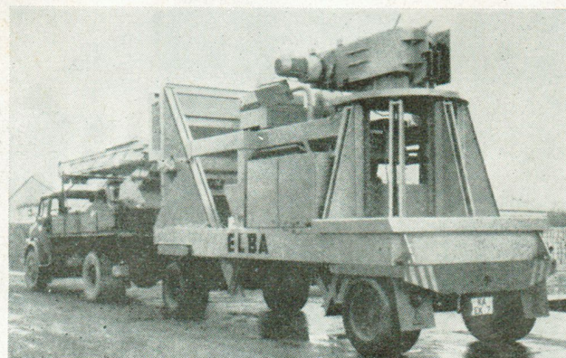
Fig. 17. Mobiele installatie in rijstelling.
