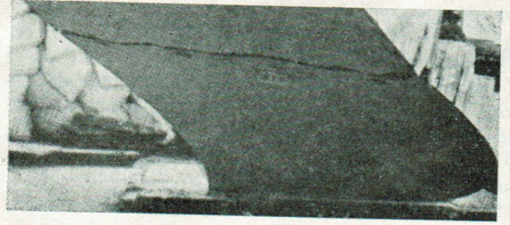
Fig. 6. Scheur in het middengedeelte, onmiddellijk voor het bezwijken van Model 2.
